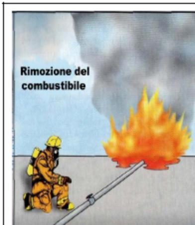
Fig. 18 – Esaurimento combustibile
